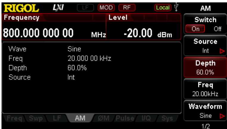
Рисунок 11. Интерфейс настройки параметров выходного модулированного радиосигнала
