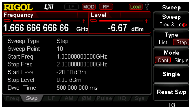
Рисунок 10. Интерфейс настройки параметров выходного сигнала радиочастотной развертки
