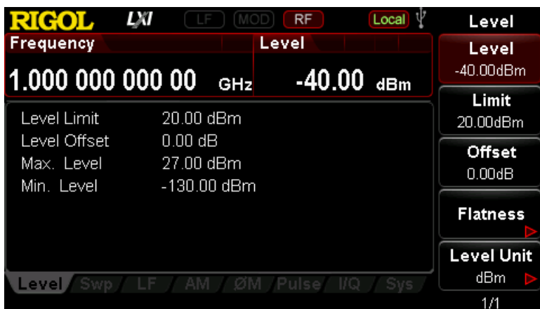
Рисунок 9. Интерфейс настройки параметров выхода радиосигнала
